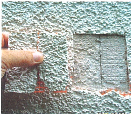
Bilder 11 bis 13: Hier wird das Vorgehen zur Prüfung einer Fassade mit Rissbildung gezeigt.
