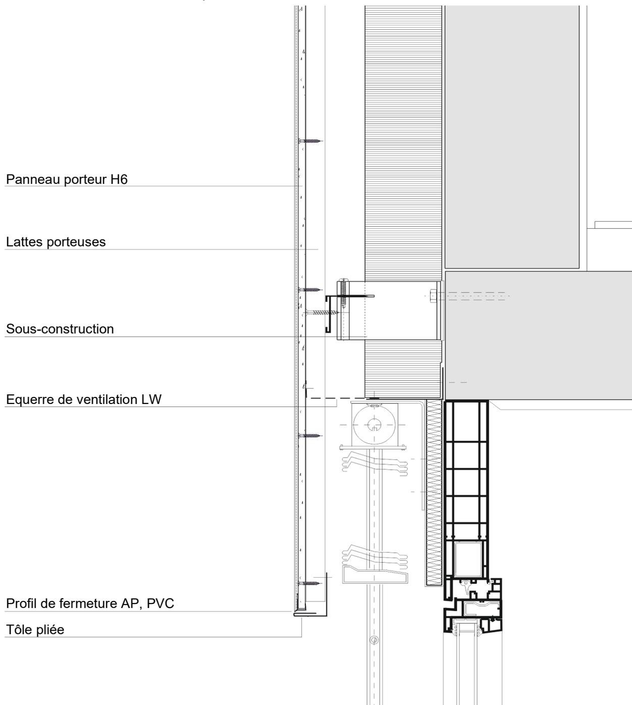
Le raccordement du châssis de fenêtre avec le composant voisin doit être étanche côté chaud. (Norme SIA 331 fenêtres)
