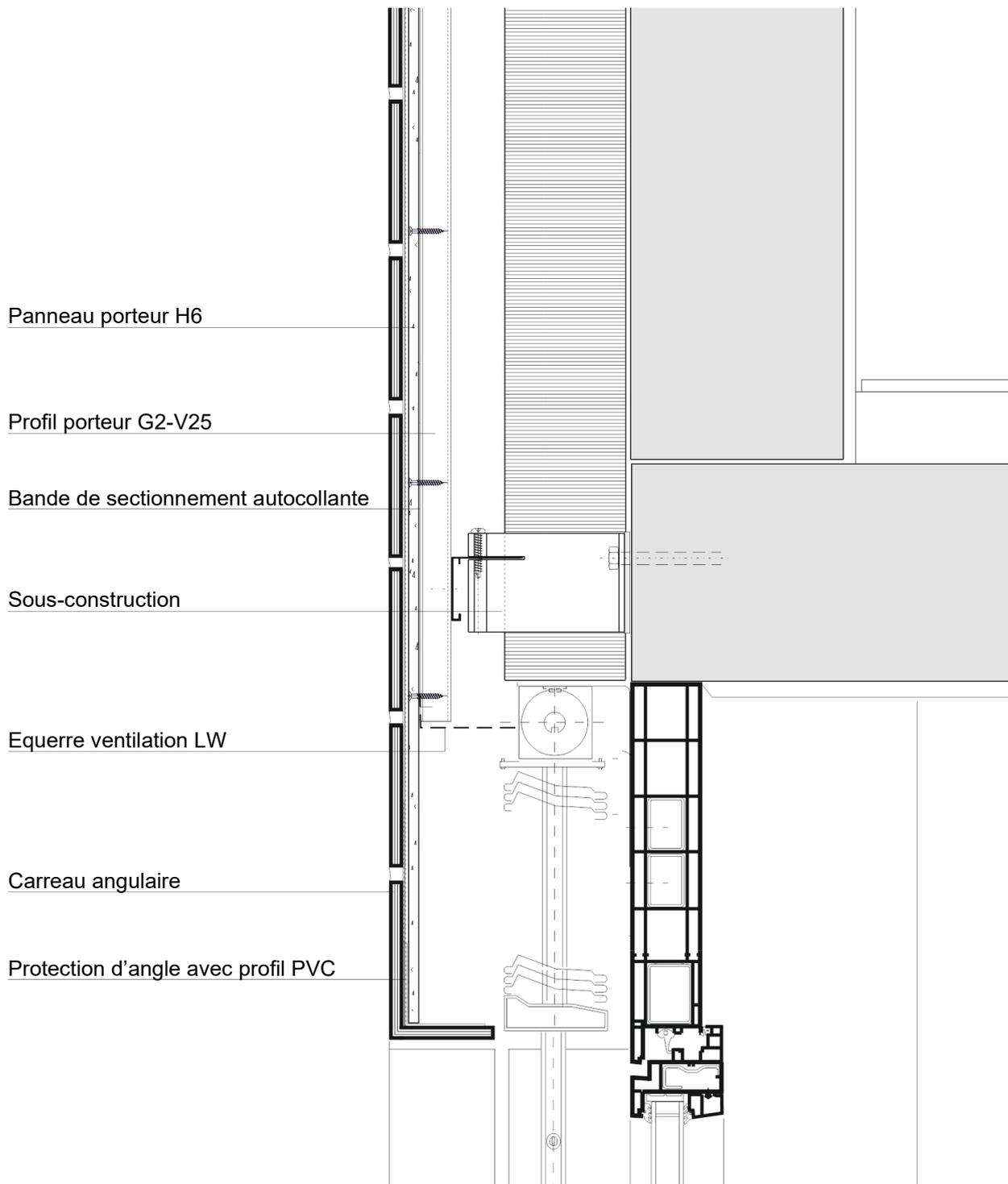
Le raccordement du châssis de fenêtre avec le composant voisin doit être étanche côté chaud. (Norme SIA 331 fenêtres)
