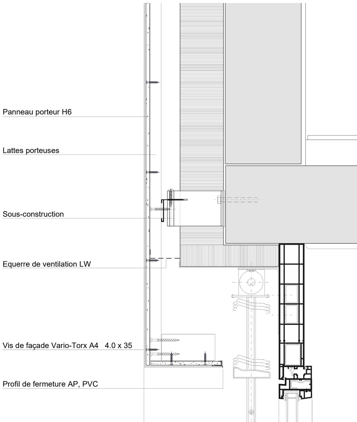
Le raccordement du châssis de fenêtre avec le composant voisin doit être étanche côté chaud.
